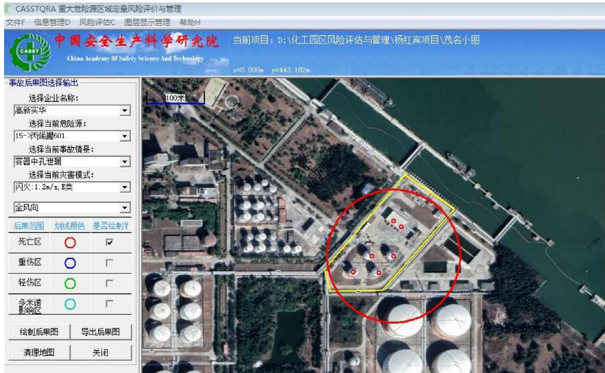
图 5.13-2 球罐 601 容器中孔泄漏闪火事故后果模拟输出图
