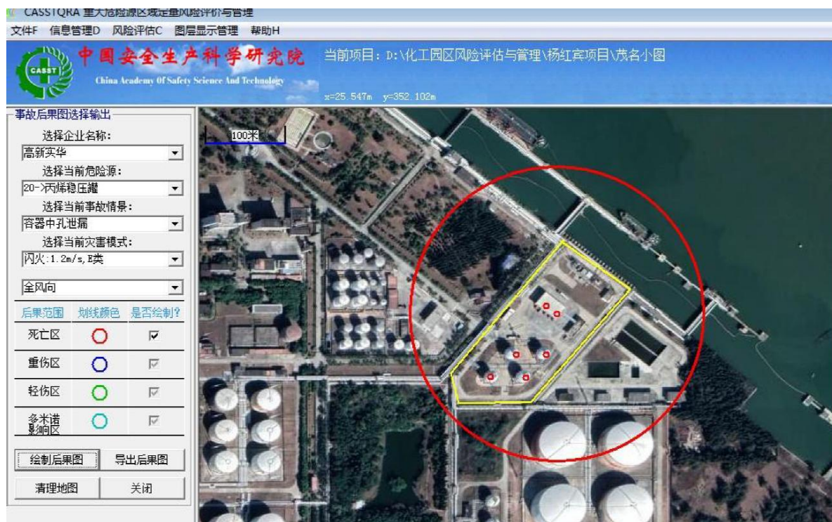
图 5.13-6 稳压罐容器中孔泄漏闪火事故后果模拟输出图
