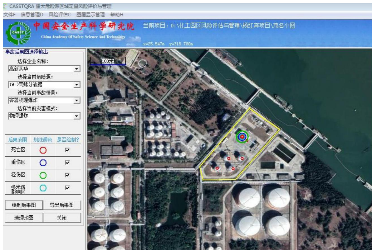
图 5.13-4 分液罐容器中孔泄漏闪火事故后果模拟输出图
