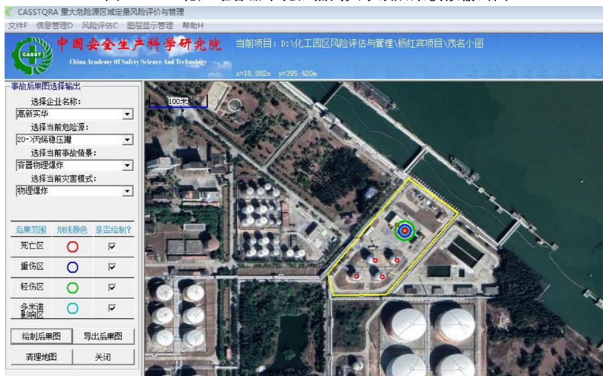
图 5.13-6 稳压罐容器中孔泄漏闪火事故后果模拟输出图
